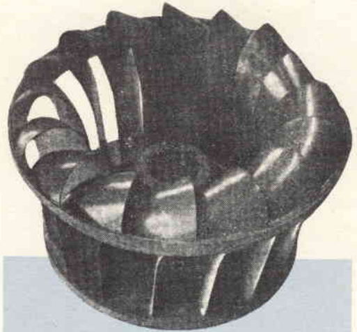
Nella girante di una turbina Francis le pale hanno la caratteristica forma a doppia curvatura.
