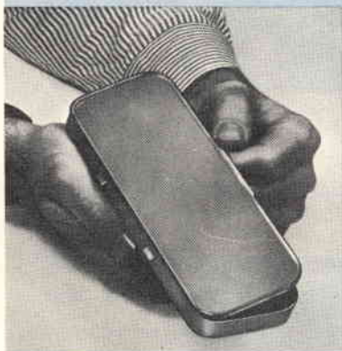
Fig. 7 - Per rimontare lo specchio si introducono, prima di tutto, i perni a linguetta saldati nella cornice nelle fessure praticate nella scatola.
